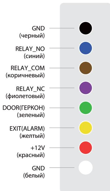
Распиновка 8-ми жильного кабеля JST (питание, замок, подключение устройств)
